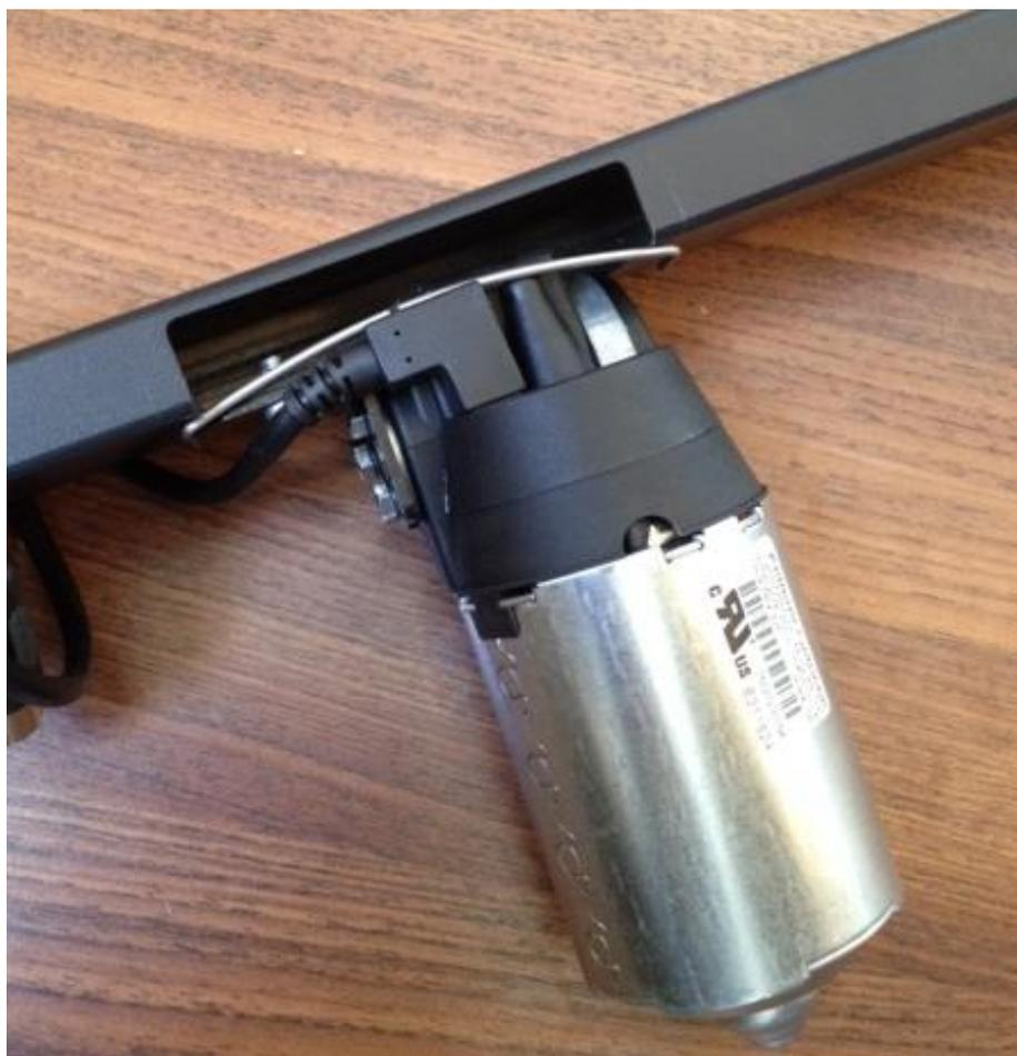
6.1.3 Monter le ressort de blocage du moteur
