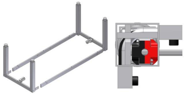
6.1.5 Monter les 2 montants longs. Important: Pousser très fermement les 2 montants contre chaque pied avant de serrer les vis. Serrez les boulons à l'aide de la clé fournie.
