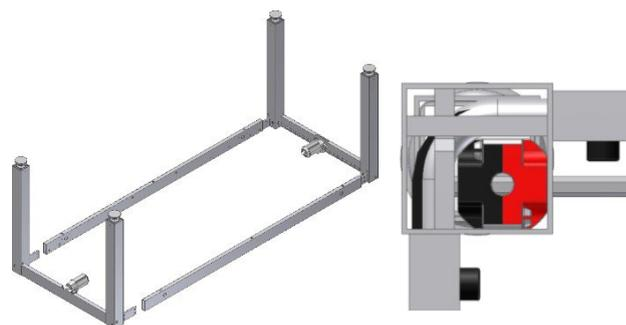
6.1.5 Montez maintenant les deux panneaux frontaux. Important : Pousser fermement les fascias latéraux et avant contre le pied avant de resserrer les fascias. Serrer fermement les boulons à l'aide de la clé fournie.
