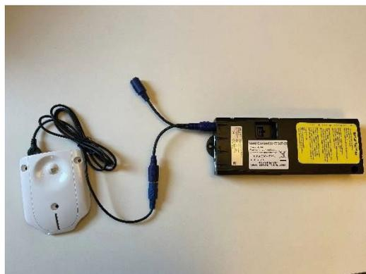
6.1.1.2 Insérez le câble divisé dans la fiche « HS » dans le boîtier de commande. Ensuite, insérez le adaptateur à une extrémité de la fente câble et le bouton fourni avec le produit, dans l'autre
