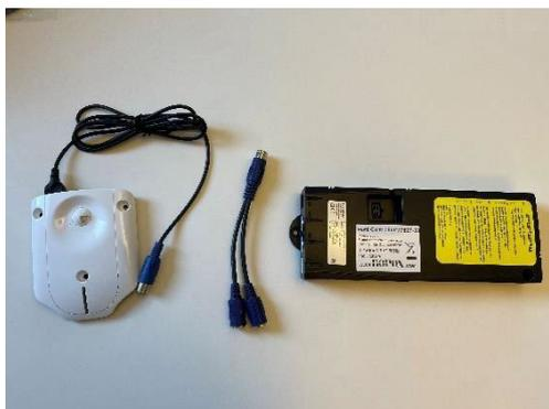
6.1.1.1 Déterminer l'emplacement du adaptateur, puis prenez le Bluetooth l'adaptateur et le câble divisé
