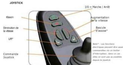
Pour accéder à la seconde fonction (par ex « Bascule d'assise », si équipée), vous pouvez soit appuyer directement sur le bouton de droite, soit, si vous venez d'utiliser le bouton de gauche (« Lift »), simplement dépalcer le joystick à droite. Une fois la fonction sélectionnée, poussez ou tirez sur le joystick pour utiser la fonction
