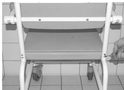
Les vis sont serrées à l'aide de la clé Allen lors du montage à l'arrière.
