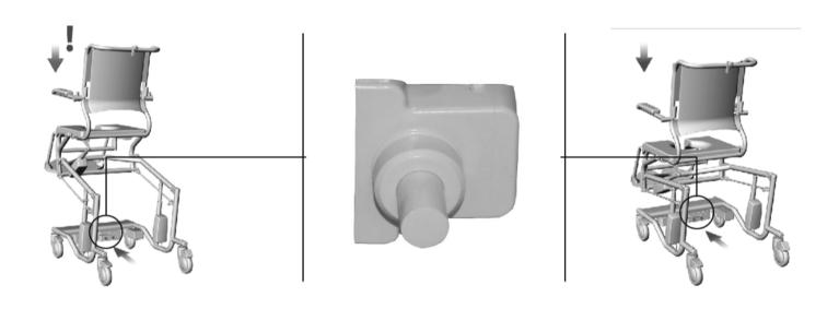
**Faire un reset.** Si toutes les diodes clignotent, il y a une erreur système. Il faut alors appuyer sur le bouton "STOP" de la télécommande jusqu'à ce que les 2 diodes de flèches s'allument. Ensuite presser le bouton d'urgence sur l'arrière du boitier électrique en bas de la chaise jusqu'à la descente complète de l'assise et le dossier en position la plus en arrière.
