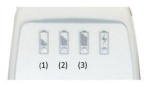
Manque de puissance : Lorsque la diode (3) s'éteint ainsi que la diode S, et qu'il ne reste plus que les diodes (2) et / ou (1) allumées, la chaise commence à bipper. Elle manque alors de charge et doit être rechargée (voir plus haut).
