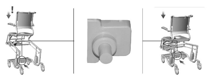
**Descente d'urgence**. Si la télécommande ne veut pas descendre l'assise, appuyer sur le bouton de descente d'urgence situé sur le boitier électrique au bas de la chaise jusqu'à arriver en position la plus basse. NB! Cette operation démarre 5 secondes après avoir entendu les 5 bips. NB! La diode de puissance clignote lorsque le bouton d'urgence est pressé.
