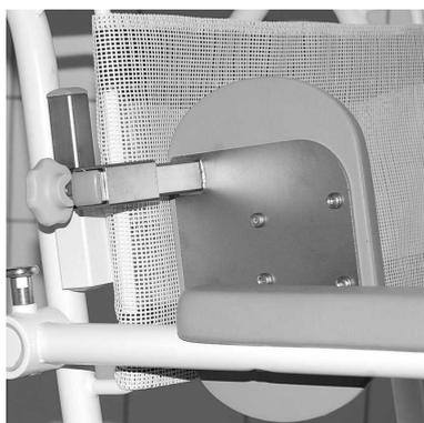
Les supports latéraux sont encliquetés dans les tubes carrés du cadre. Pour ajuster la profondeur, desserrez la vis à réglage manuel et resserrez à la bonne position.
