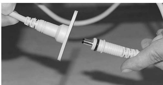
Lors du chargement de la batterie, débranchez le câble d'alimentation du chargeur et insérez la fiche du chargeur.
