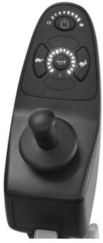
Lorsque le levier de commande est relâché, les roues arrière sont automatiquement freinées afin que le fauteuil reste en place.
