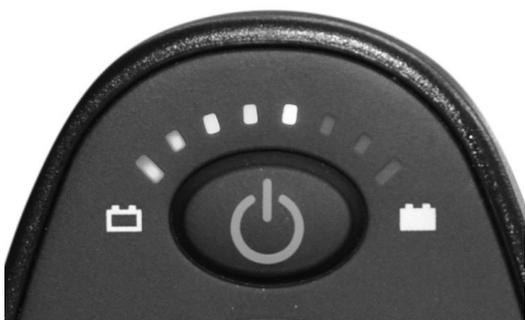
Une lumière sur la console du joystick indique la charge de la batterie. Lorsque les voyants verts ne s'allument plus, le fauteuil doit être mis en charge. NB! Si les batteries sont faibles, elles seront endommagées et ne pourront pas être rechargées.
