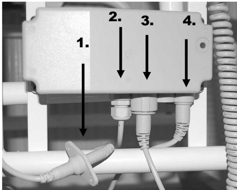
1. Insérer dans le boîtier de batterie
