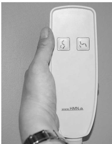
Le fauteuil est basculé en appuyant sur le bouton de la commande manuelle vers le haut ou le bas. Si l'utilisateur parvient à se tenir aux accoudoirs, l'assistant doit mettre ses mains sur ses genoux avant que le fauteuil ne bascule.
