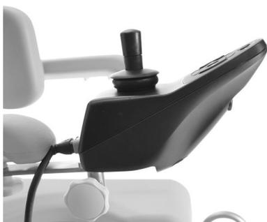
Emplacement du joystick. Le joystick peut être placé à l'avant pour le besoin de l'utilisateur ou derrière pour l'utilisation via l'aidant. Utilisez la vis à molette fixée au joystick, là où vous le souhaitez.
