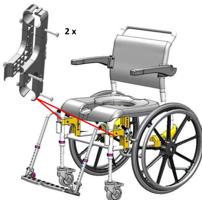
Monter les supports de roues automotrices (2 x 6 vis)
