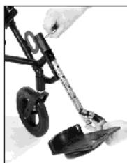
La plante des pieds et les talons doivent reposer de manière confortable sur le repose-pied. Pour y parvenir, retirer la goupille sur la face avant des montant du repose-pieds, faire glisser le repose-pieds à la hauteur voulue et remettre la goupille.. Fig. 25
