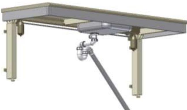
8.5.1 Toujours connecter ces raccords à l'aide de flexibles, afin de permettre le réglage en hauteur sur 30 cm (65-95 cm).
