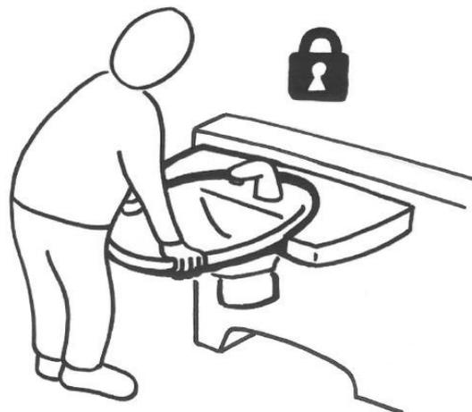
Si le lavabo est verrouillé dans la station d'accueil, il fonctionne comme un lavabo standard et peut être utilisé en toute sécurité comme support de position debout.
