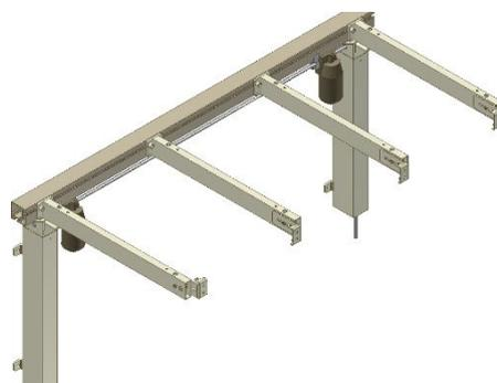
7.1.10 Le bras de fixation droit peut être inséré dans le profil, positionné directement sur le pied gauche et fixé.
