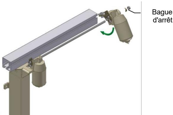
7.1.7 Pour une longueur de plan de travail de 105 à 300 cm, un moteur supplémentaire doit être monté comme décrit. Placer la rondelle et la bague d'arrêt entre le moteur et le pied droit de manière à ce que la rondelle soit orientée vers le pied.
