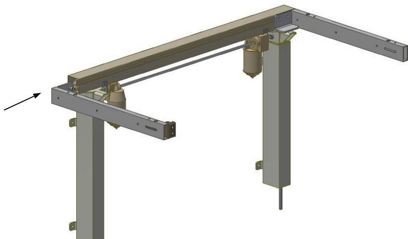
8.6.1 Pousser le bras de fixation dans le profilé en aluminium et s'assurer que le bras de fixation est au même niveau que le profilé. Ensuite, serrer les vis.
