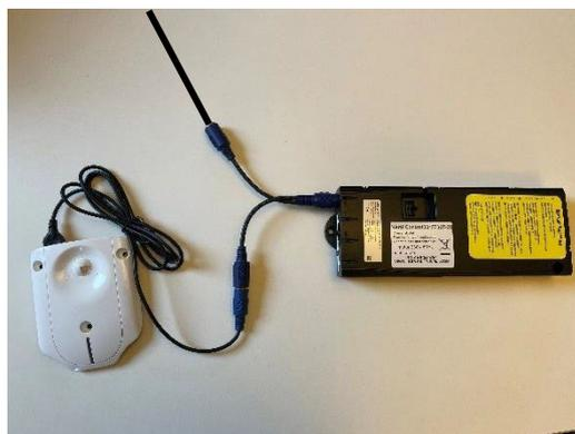
8.7.2 Insérer le câble divisé dans la prise "HS" dans la boîte de contrôle. Insérer ensuite l'adaptateur dans l'une des extrémités de la fente et le bouton fourni avec le produit, dans l'autre.
