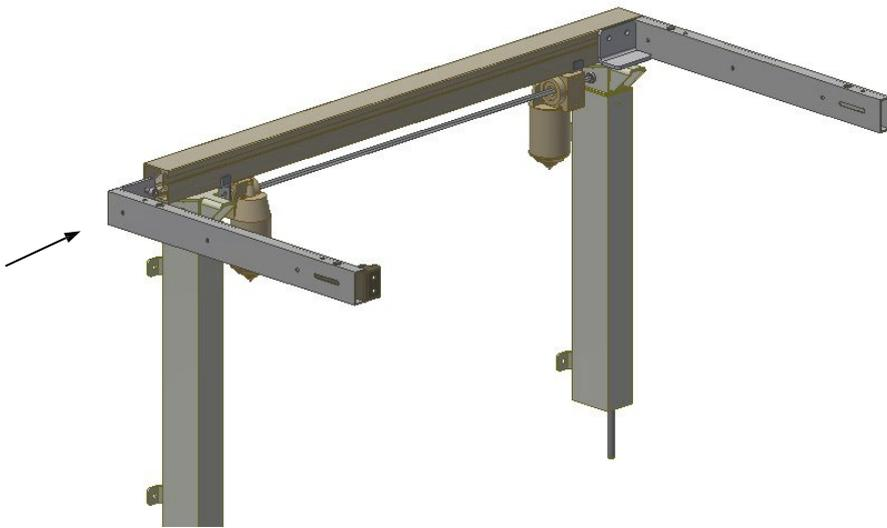
7.9.1 Pousser le bras de fixation dans le profilé en aluminium et s'assurer que le bras de fixation est au même niveau que le profilé. Ensuite, serrer les vis.
