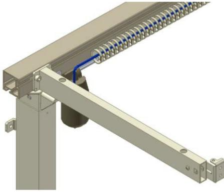
7.4.2 Placer les câbles en vrac dans des tubes de câbles qui peuvent être montés sur un profilé en aluminium.
