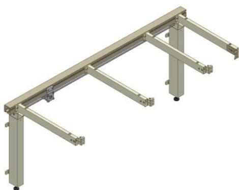
6.3.1 Placer le cadre contre le mur et l'aligner. Ajustez les deux boulons filetés sous les pieds pour que le cadre soit horizontal.
