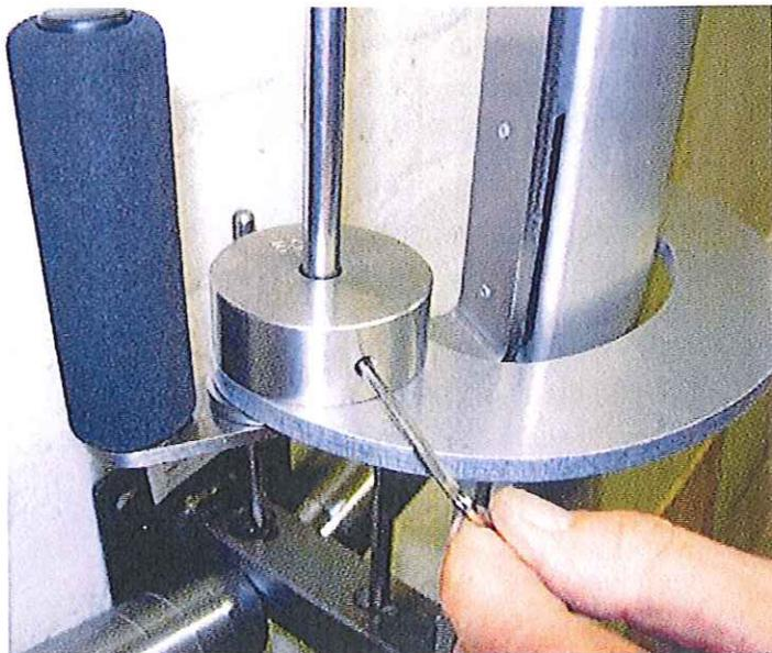
Figure 19: Fixation du synchronisateur
