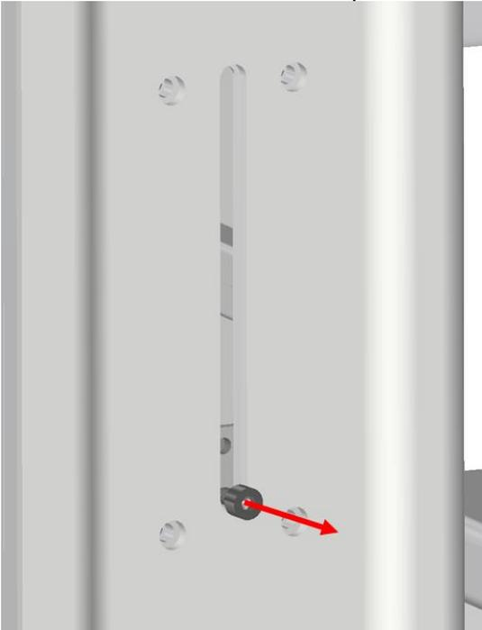
2. Fixer le support avec 4 vis M6x30 + rondelles (incluses) dans les 4 trous filetés du releveur de toilettes. Ne pas serrer trop fort les vis de manière à ce que le support puisse se déplacer librement de haut en bas dans les fentes. Elles seront ajustées plus tard.
