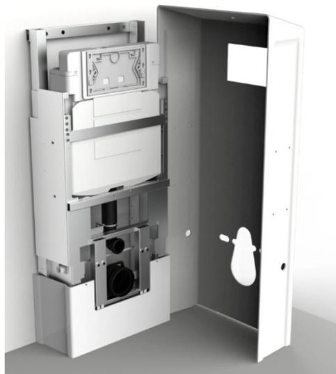
**b.** Faites passer le câble le long de l'avant de l'unité de levage et tirez-le derrière la barre transversale située sous le réservoir de chasse, comme indiqué sur l'illustration.
