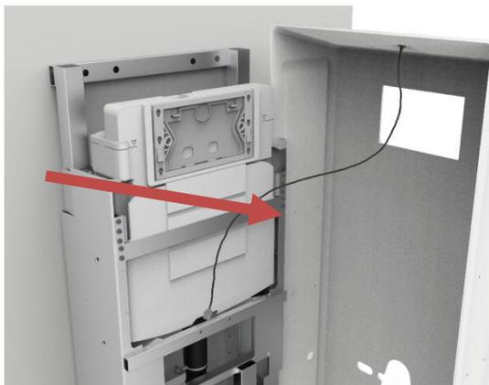
**c.** Démontez le boîtier de commande de l'unité de levage et insérez la fiche de la commande fixe. Fermez le couvercle et remettez le boîtier de contrôle en place.
