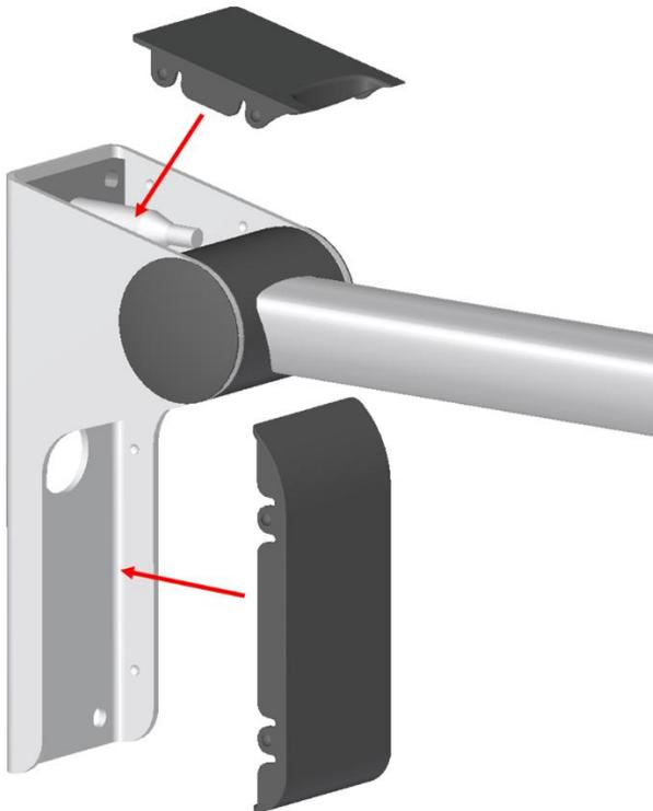
6. Réglez la résistance et le relâchement du support sur les 4 vis M6x30 qui passent dans les fentes. Réglez le support de manière à laisser le moins de marge de manœuvre possible sans pour autant rendre difficile la montée et la descente. Faites bouger l'accoudoir latéralement pour évaluer s'il est suffisamment ferme. S'il semble très lâche, serrez un peu les vis jusqu'à ce que la tolérance soit satisfaisante. N.B. Le support doit rester réglable en hauteur.
