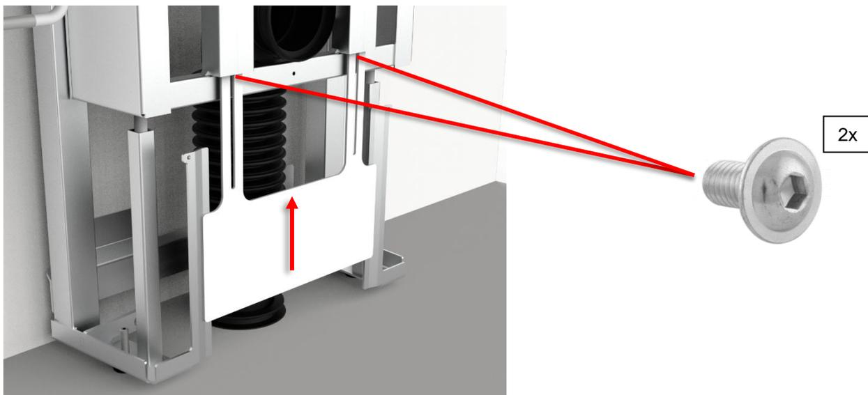
Avant de monter le couvercle intérieur 2, si les couvercles d'extension ont été achetés, ils doivent être montés au préalable. Voir 4.4.5
