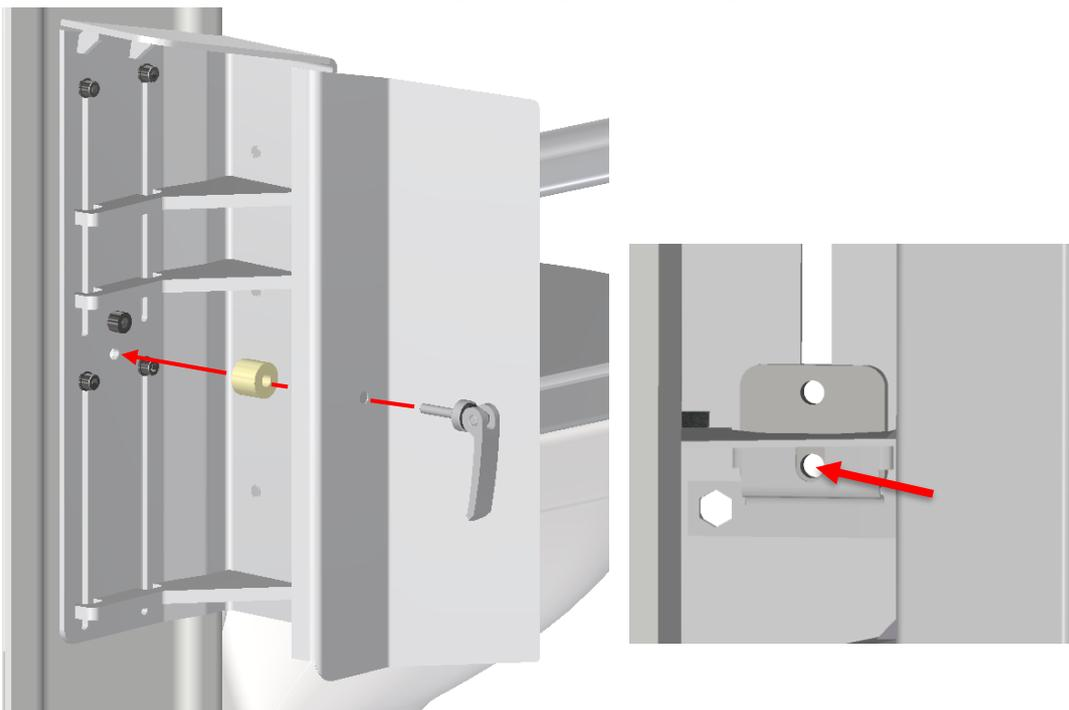
8. Régler le levier de blocage de sorte à ce que le support puisse librement se régler vers le haut et vers le bas en position ouverte et qu'il verrouille efficacement le support en position fermée. Le réglage s'effectue en tournant la vis de réglage.
