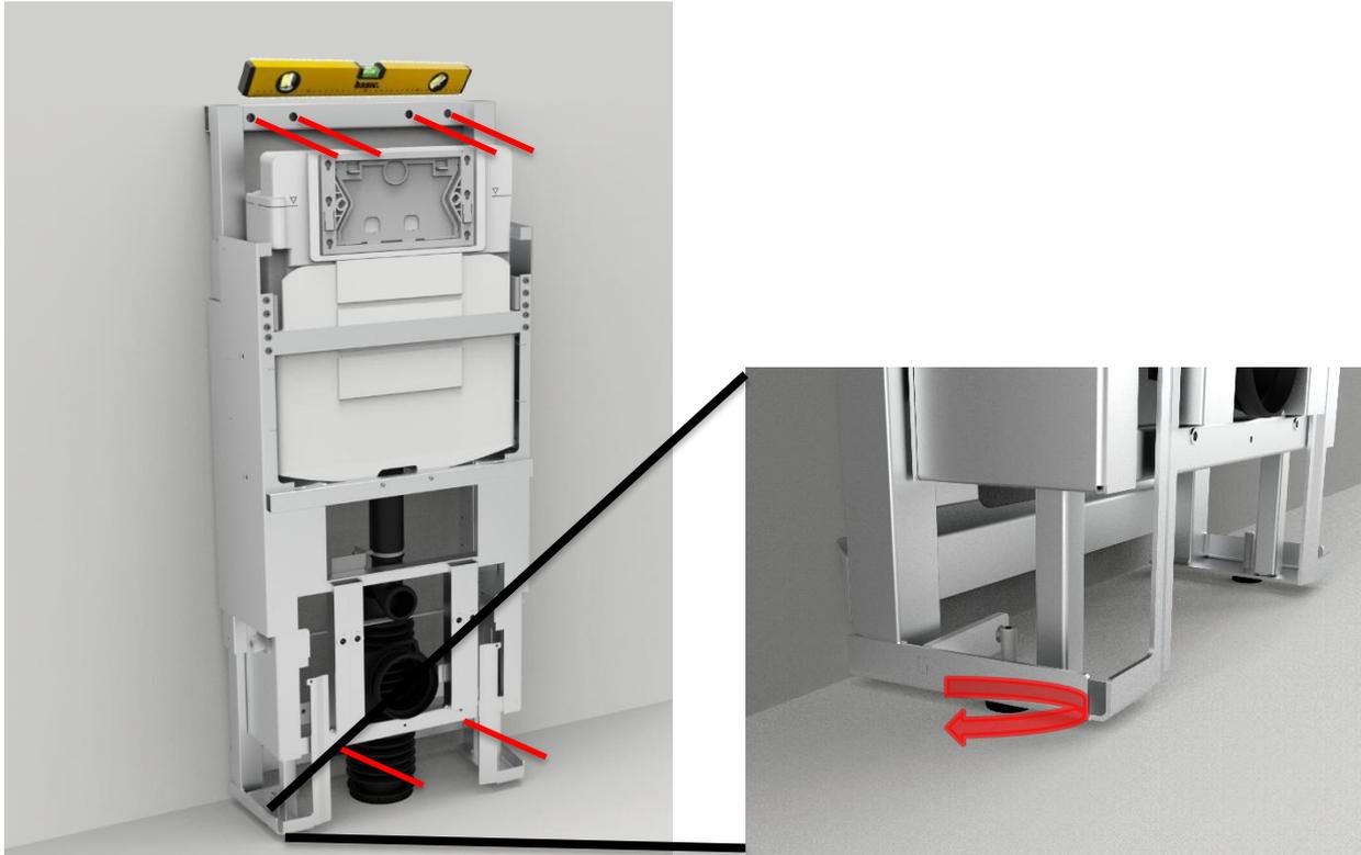
**a.** Aligner le cadre avec les vis de réglage. Tracer 6 trous et percer les trous pour les chevilles appropriées. Veillez à ce que le centre des deux trous inférieurs soit au moins à 130 mm au-dessus du sol.
