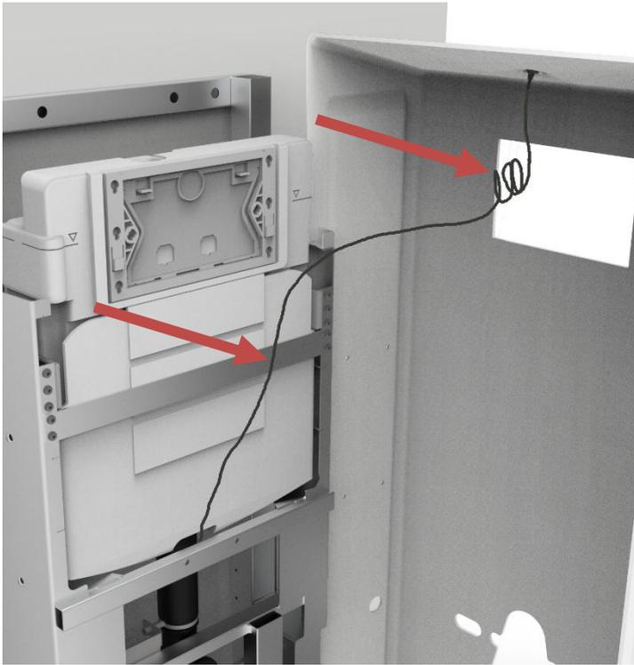
**d.** Utilisez les bandes jointes pour fixer le câble à la courroie comme indiqué. Enrouler le reste du câble et le dénuder en un faisceau, aussi près que possible du haut du couvercle.
