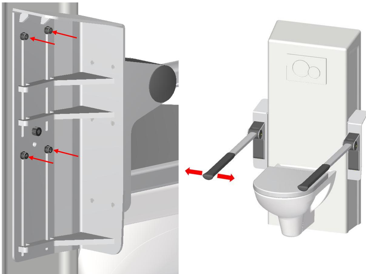
7. Monter l'entretoise avec le cache protecteur en plaçant le levier de blocage dans le trou inférieur au centre du support ; le levier de blocage doit également s'engager dans l'écrou de plaque à l'arrière.
