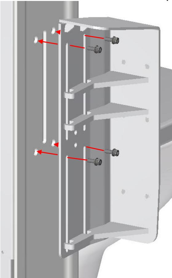
3. Mettre la vis M8x20 + la rondelle dans le trou supérieur au centre du support. Elle doit s'insérer et attraper l'écrou de plaque à l'arrière. Notez que c'est le trou supérieur de l'écrou de plaque dans lequel la vis est insérée. Ne pas serrer la vis trop fort car elle ne sert qu'à contrôler l'écrou de plaque.
