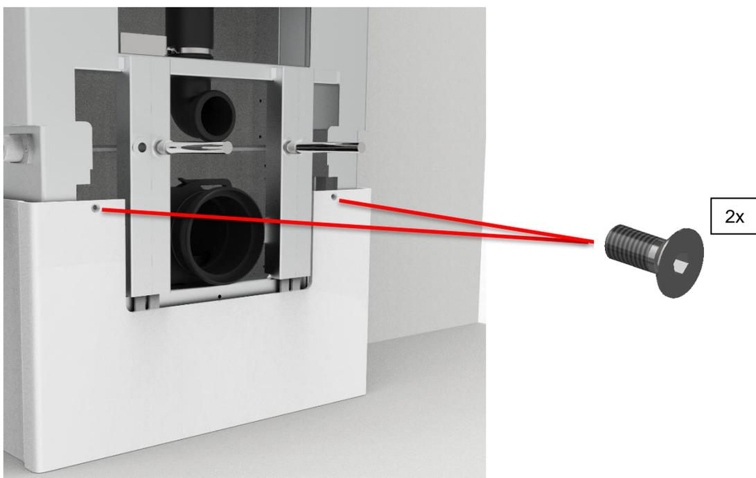
**g.** Monter le couvercle extérieur (si la version avec commande fixe dans la partie supérieure du couvercle est installée, veuillez passer à la section 4.4.4 - montage de la commande fixe dans la partie supérieure du couvercle). Si les couvercles d'extension ont été achetés, ils doivent être montés avant le couvercle extérieur. Voir 4.4.5
